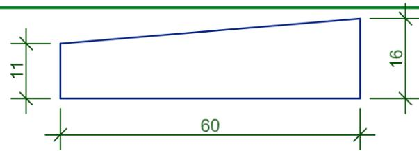
Taille et forme réelles du tenon passant (8 mm d'épaisseur)
