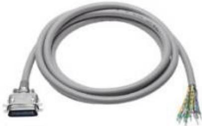
**Conception :** Un connecteur d'extrémité Syslink à 24 broches, l'autre extrémité étant ouverte avec des viroles (ferrules). Les broches 9 et 10, 21 et 22, 23 et 24 sont interconnectées.
