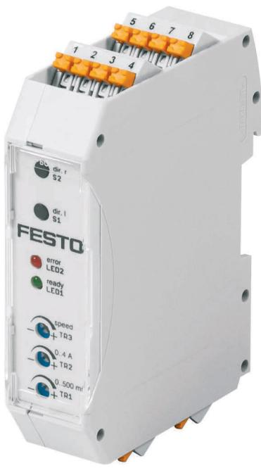
Le contrôleur de moteur est une commande pour moteurs à balais à courant continu et surveillance de surintensité réglable. Une sortie d'état signale les états « Prêt » et « Défaut ».
